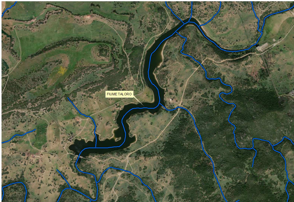
Figura 8: Esempio di elemento idrico principale che attraversa un invaso, rappresentato da una linea virtuale che segua la mezzeria dello stesso invaso o lago, in cui gli elementi idrici confluenti sono prolungati fino alla linea virtuale prodotta.
