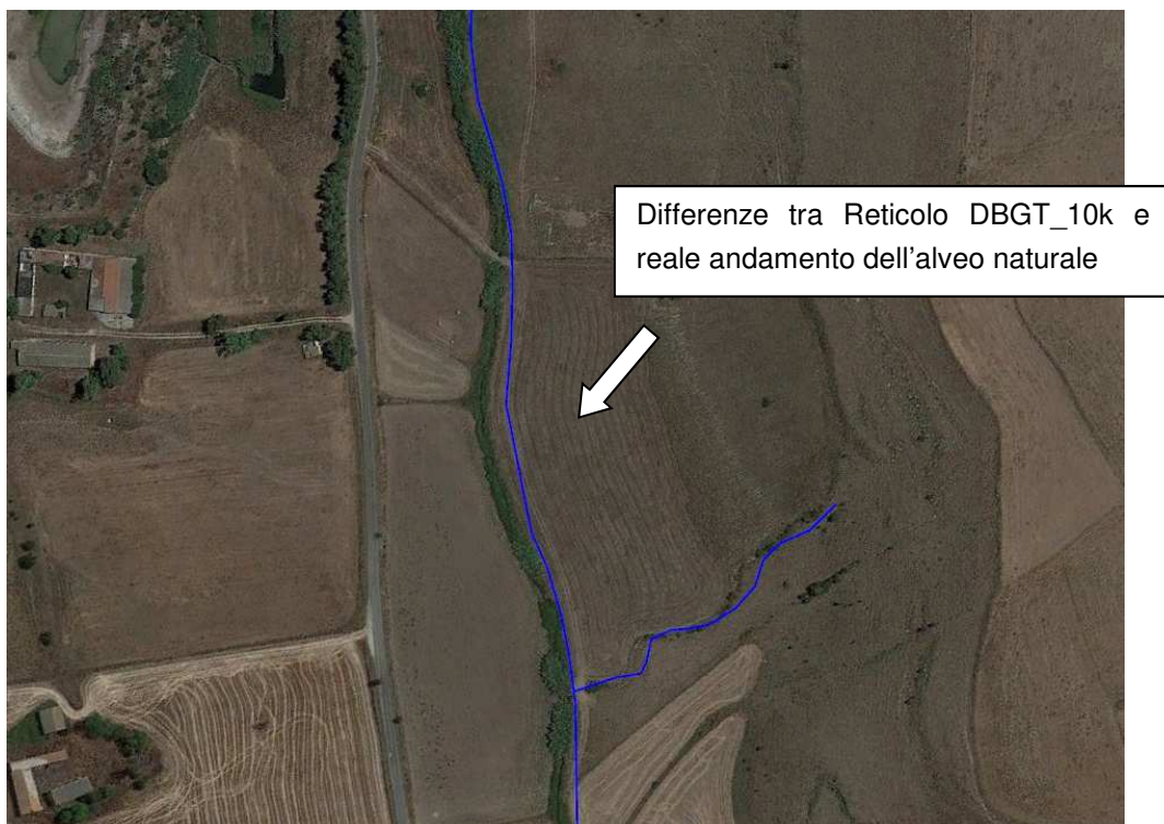
Figura 2 : Tracciato di corso d'acqua presente nel reticolo DBGT_10k non corrispondente al tracciato reale attuale.
