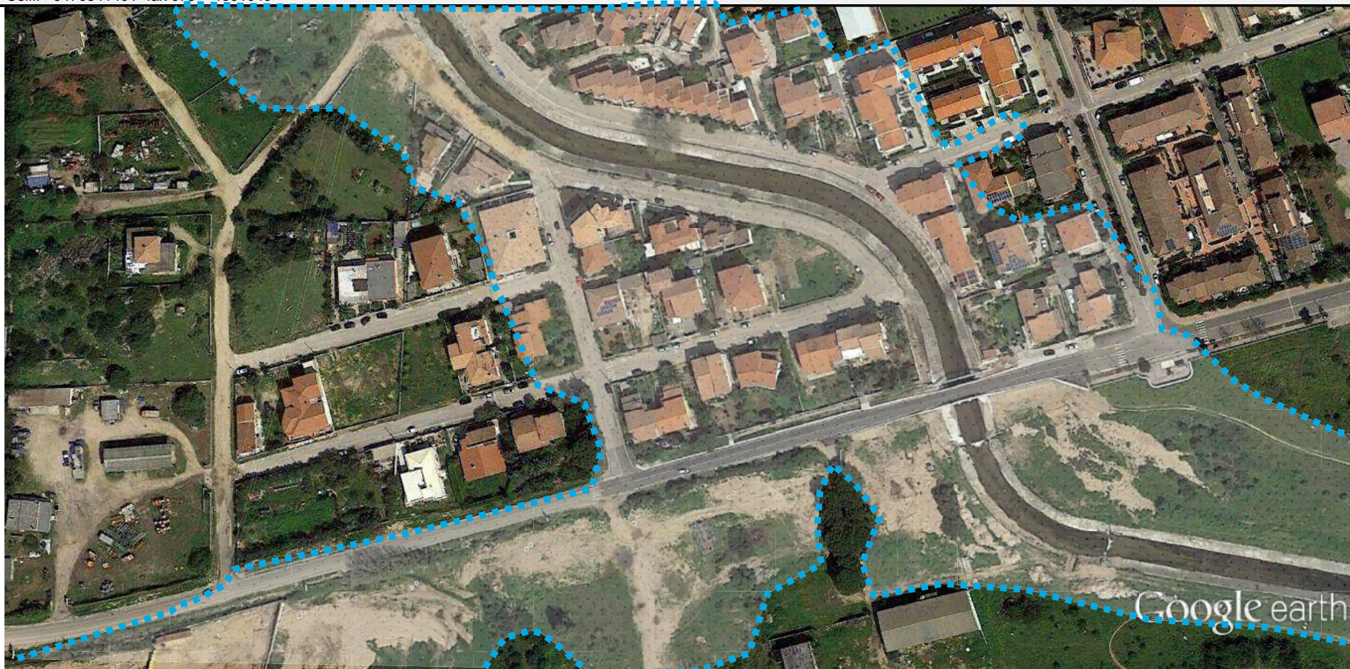
6-Intersezione via V. Vento. Effetti complessivi a valle della strada, sia per il trabocco delle portate su di essa e successiva espansione che come effetto dei canaletti da SW di Pasana
