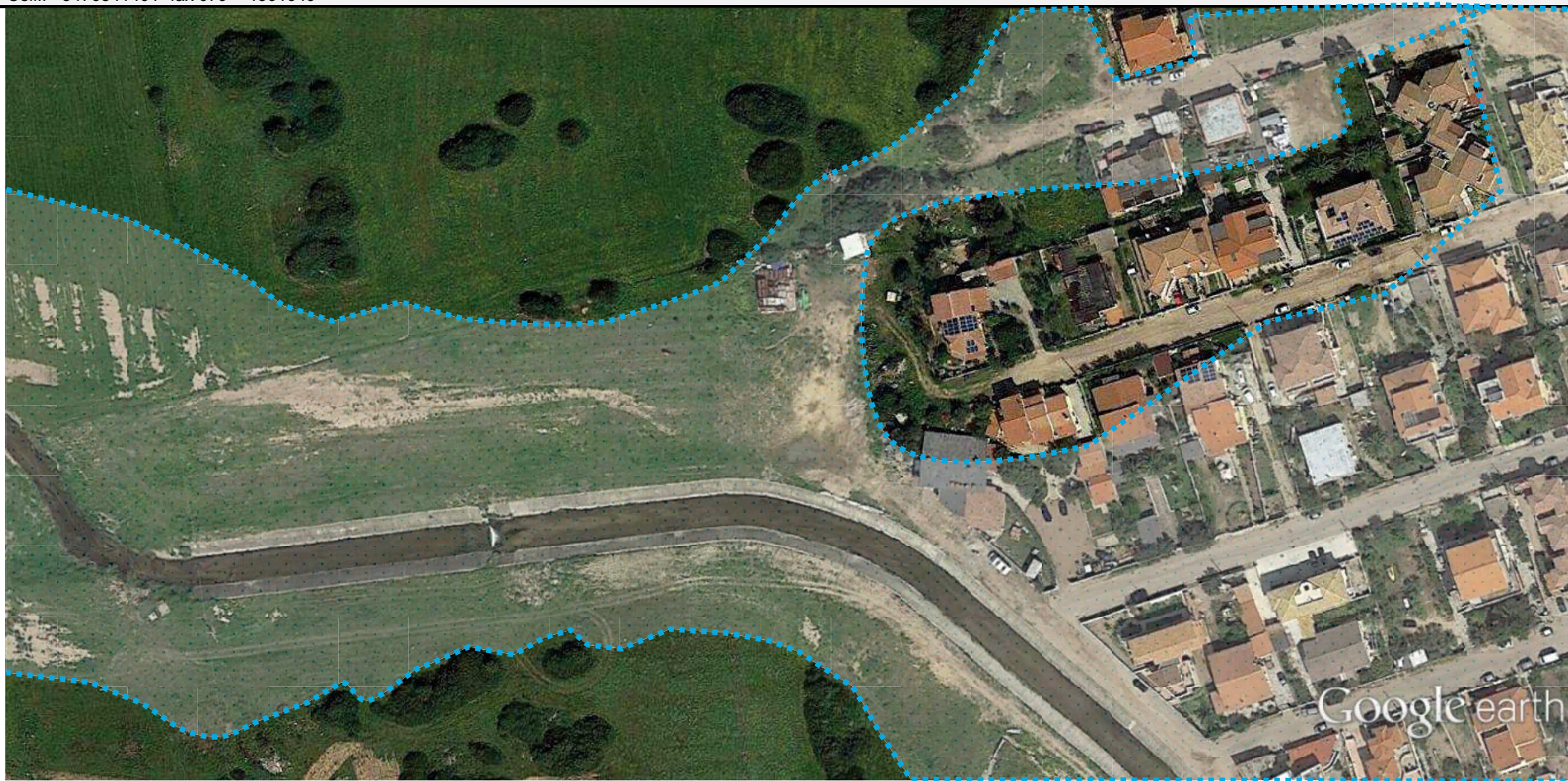
4-Tratto in cui inizia il flusso d'ondazione che determina il travaso dal sistema del S'Eligheddu a quello del Gadduresu
