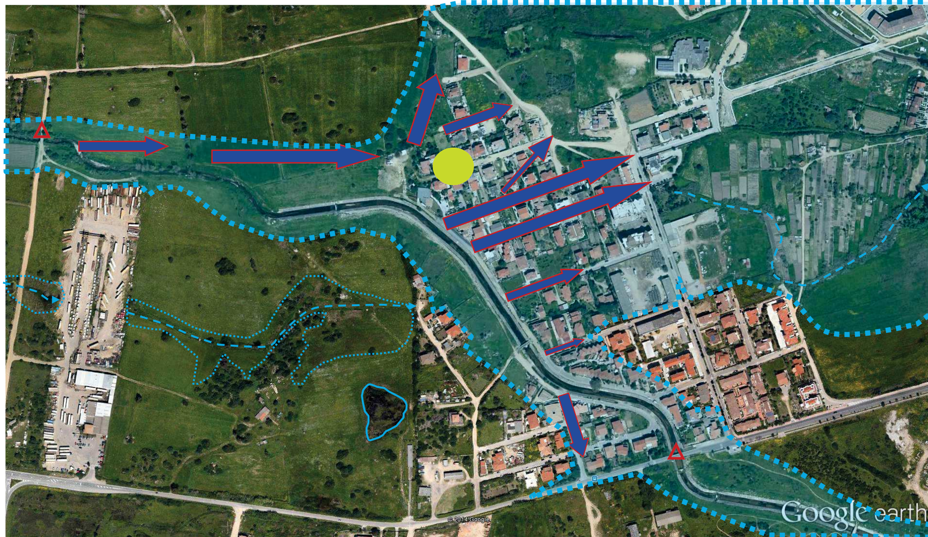
2-Il tratto da Deposito container a Ponte via V. Veneto è delimitato dai due triangoli rossi. Inquadramento e schematizzazione del flusso con cui parte della portata del S'Eligheddu travasa sul bacino del Gadduresu Predisposizione della variante al Piano di Assetto Idrogeologico (PAI) e del quadro delle opere di mitigazione del rischio idraulico nel territorio comunale di Olbia. Ricostruzione Geomorfológica dell'evento alluvionale del 18/11/2013
