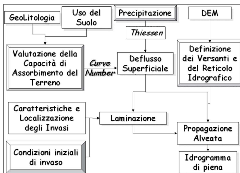
Figura 12. Diagramma a blocchi del modello idrologico idraulico FEST-RS.
