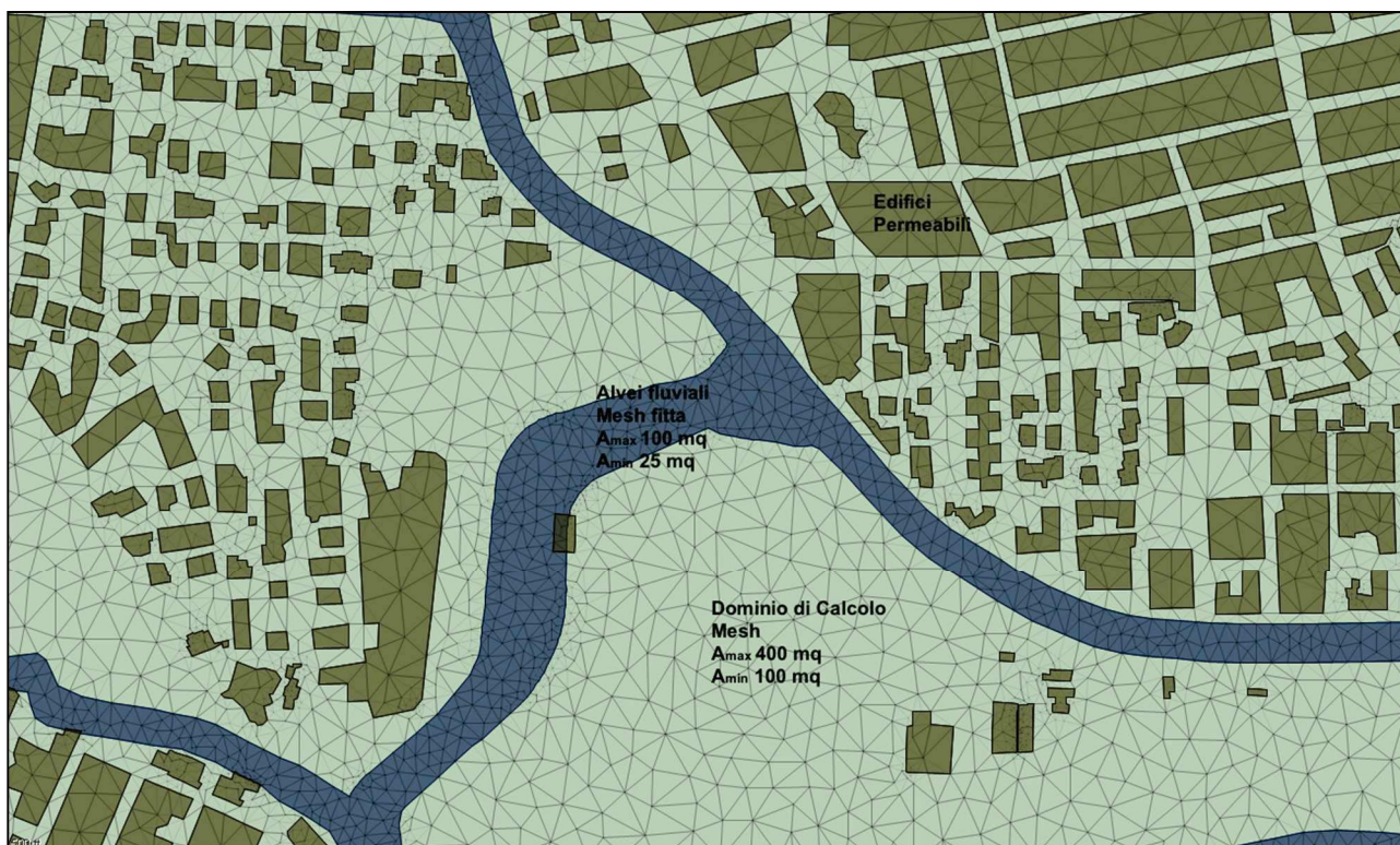
Figura 51. Estratto del modello idraulico bidimensionale nei pressi del deviatore Zozò.
