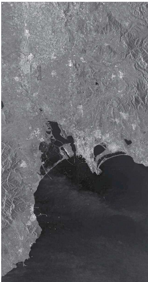
Figura 81 Scena RADAR del sensore TerraSAR, acquisita il 29 ottobre 2008 alle ore 17:14,38. L'area di interesse è definita dalla modalità di acquisizione StripMap, che da alla scena una dimensione di ripresa pari a 30 km x 50 km.
