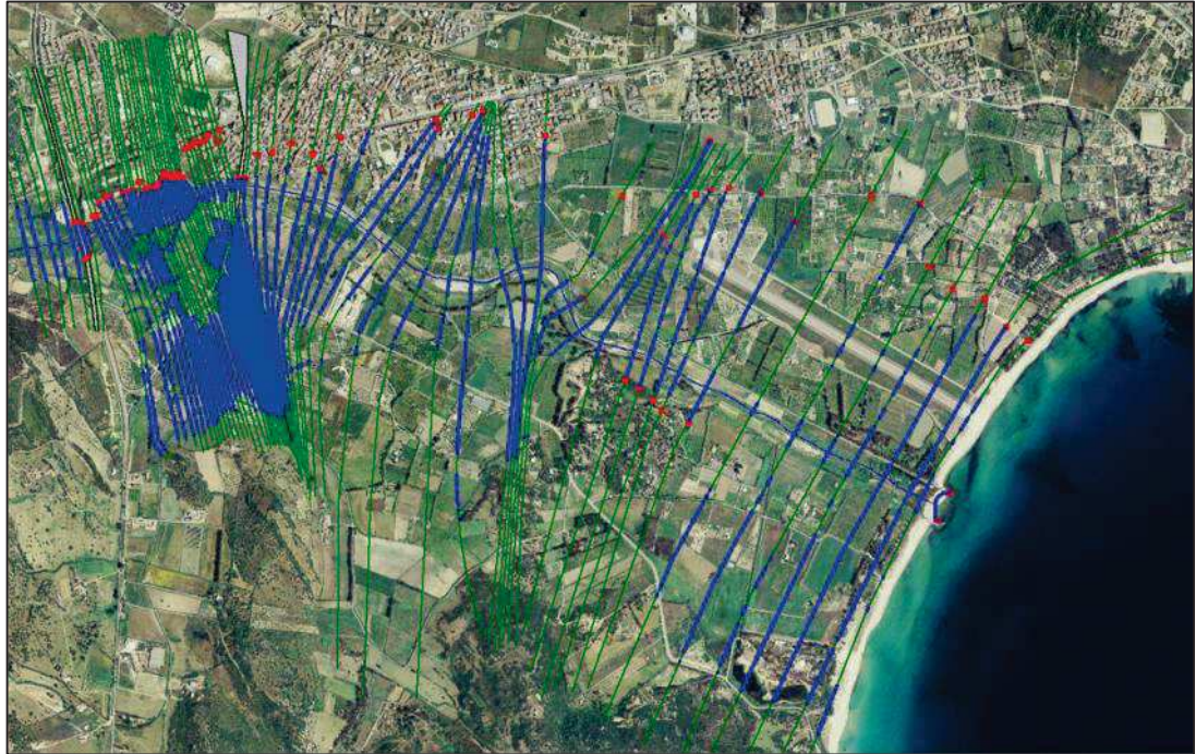
Figura 1.38 – Schema adottato per la simulazione per T200 ad argini vallivi completamente sormontabili
