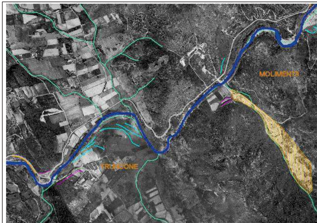
Figura 2.4 – Tratto montano: canali di erosione (celeste), difese spondali (arancio), scarpate (viola) (fonte PSFF 2013);
