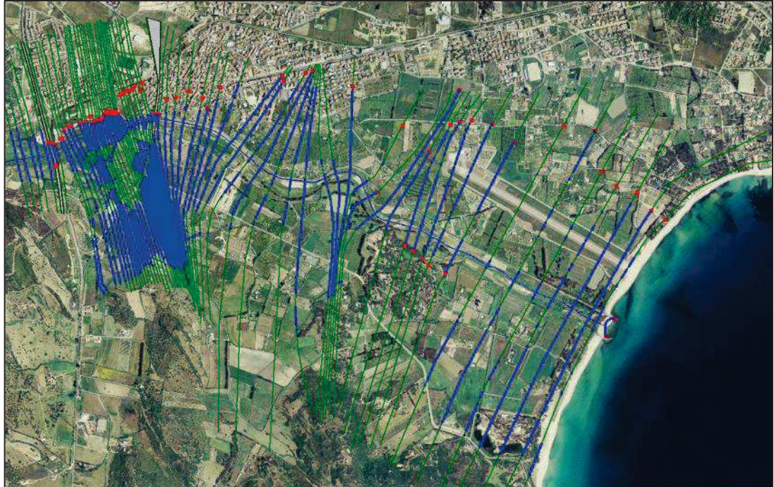
Figura 4.32 – Schema adottato per la simulazione per T200 ad argini vallivi completamente sormontabili
