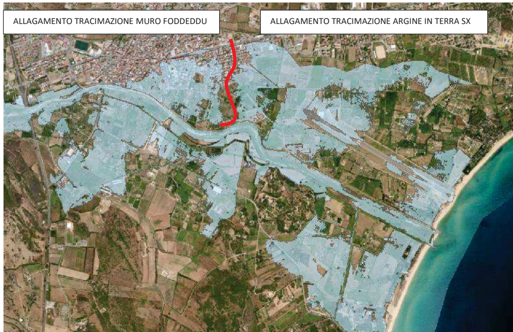
Figura 4.8 – Aree di allagamento per T100 con modellazione intermedia ad argini completamente tracimabili
