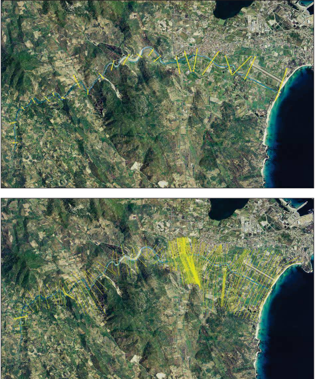
Figura 4.5 – Sezioni idrauliche analizzate nel PSFF e nella nuova modellazione con DTM 1 m
