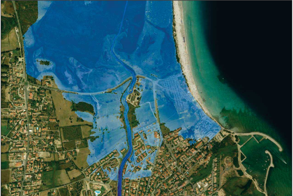
Figura 1.29 – Aree di allagamento per T100: allagamenti in via Parma, via Torino, via Pescara e Li Fureddi
