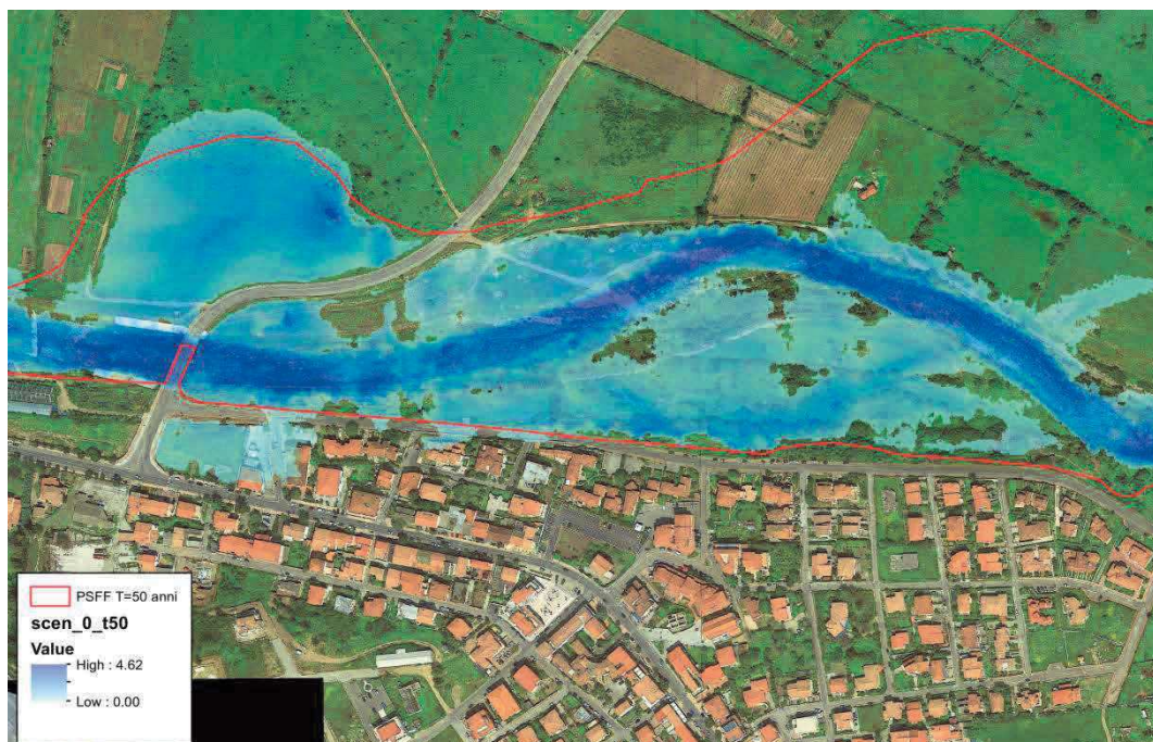
Figura 24 - Particolare dell'esondazione in destra a valle del ponte di via Foscolo
