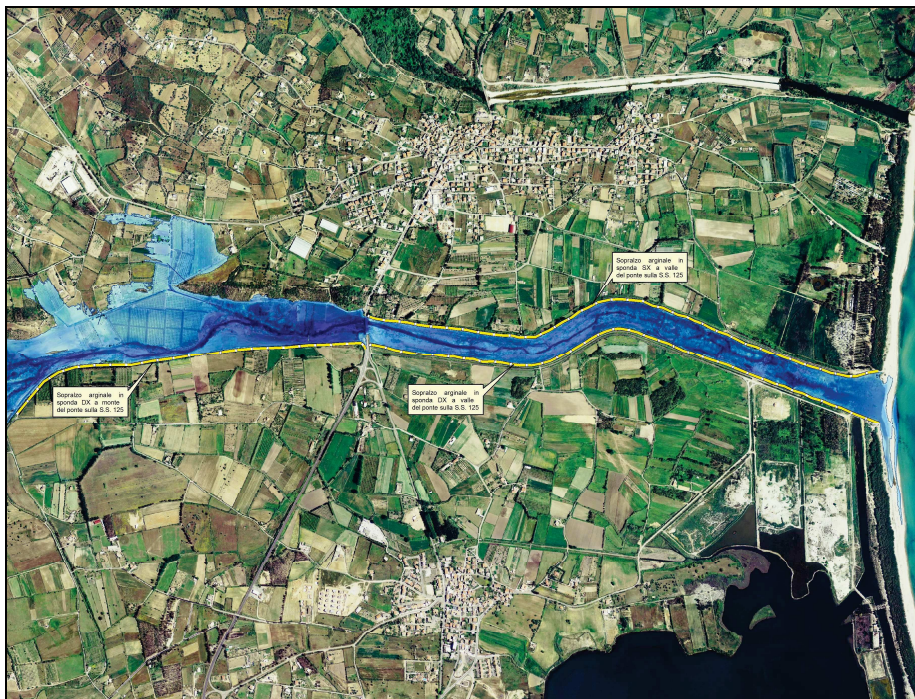
Figura 2.2 – Scenario 2: Adeguamento argine in sponda dx a monte SS 125 e a in sponda dx e sx a valle: riduzione area allagabile T_r=200
