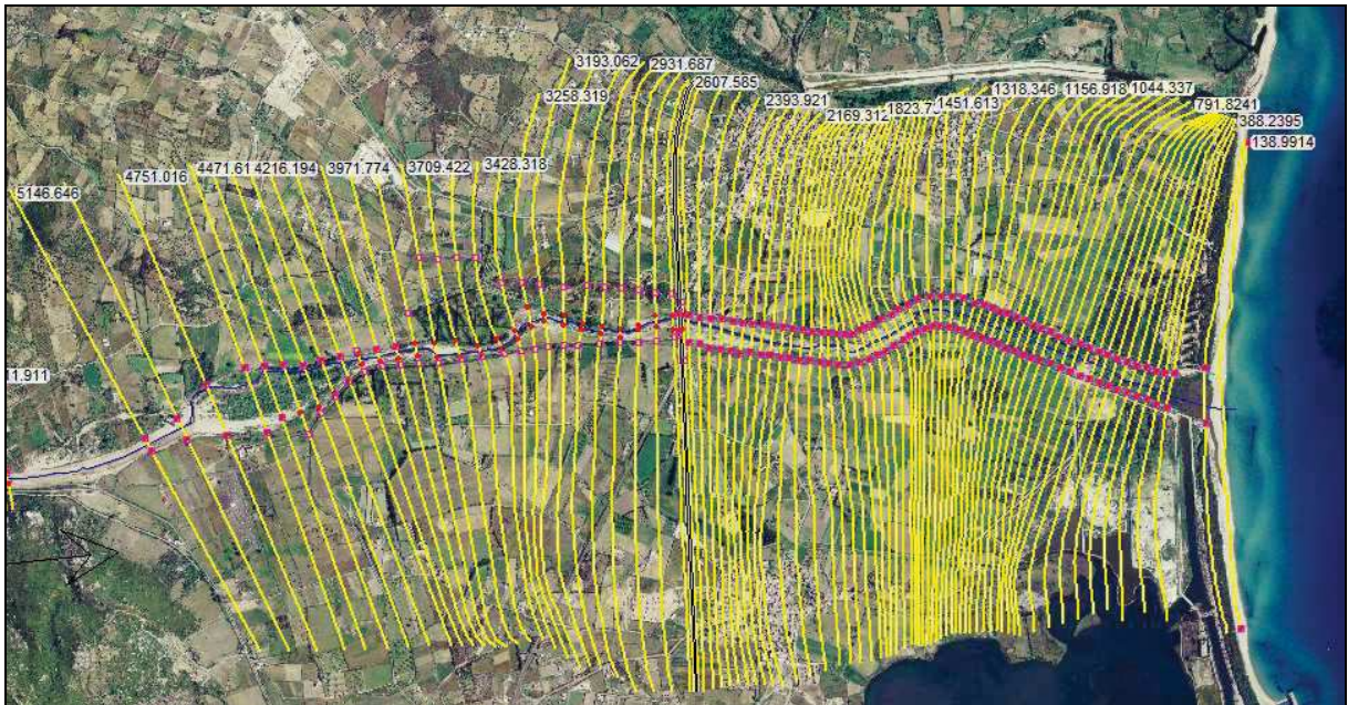
Figura 1.1 – Planimetria schematica del modello idraulico del Girasole allo stato attuale a monte e valle della SS 125
