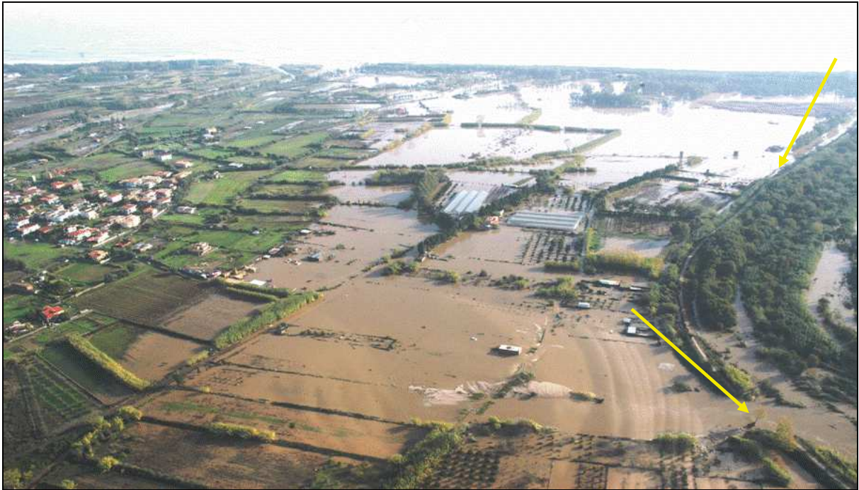
Figura 1.11 – Alluvione 28 Novembre 2008: cedimento arginale in sponda sinistra (punti indicati dalla freccia gialla)
