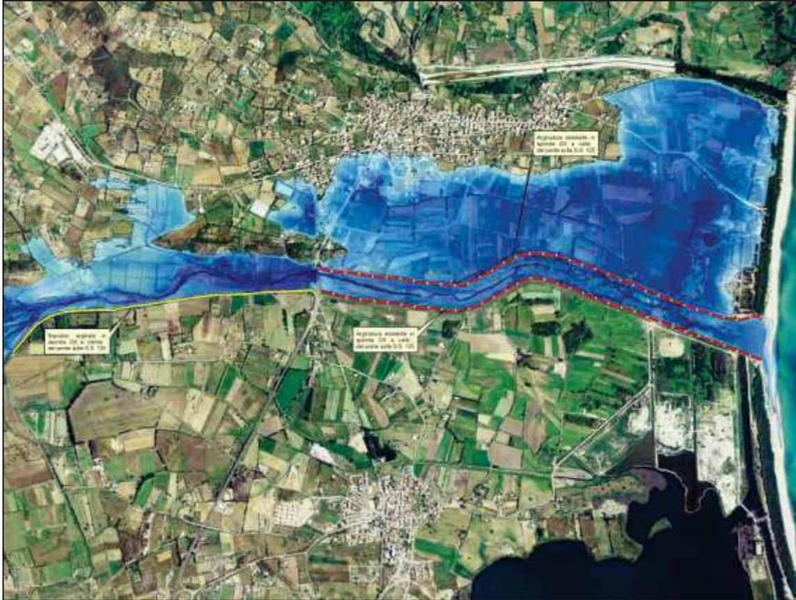
Figura 6.9 – Adeguamento in quota dell' argine in sponda destra a monte della SS 125 L = 1650 m .
