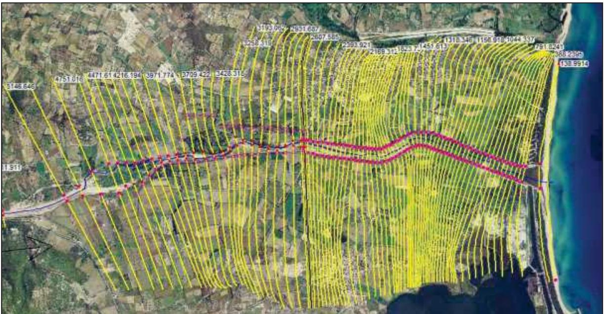
Figura 4.1 – Sezioni idrauliche analizzate nel PSFF e nella nuova modellazione con DTM 1 m
