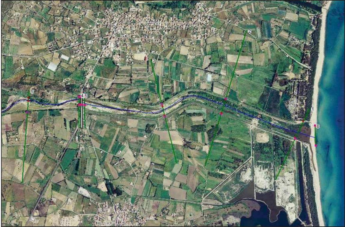
Figura 3.7 – Stralcio modello PSFF con sezioni di calcolo
