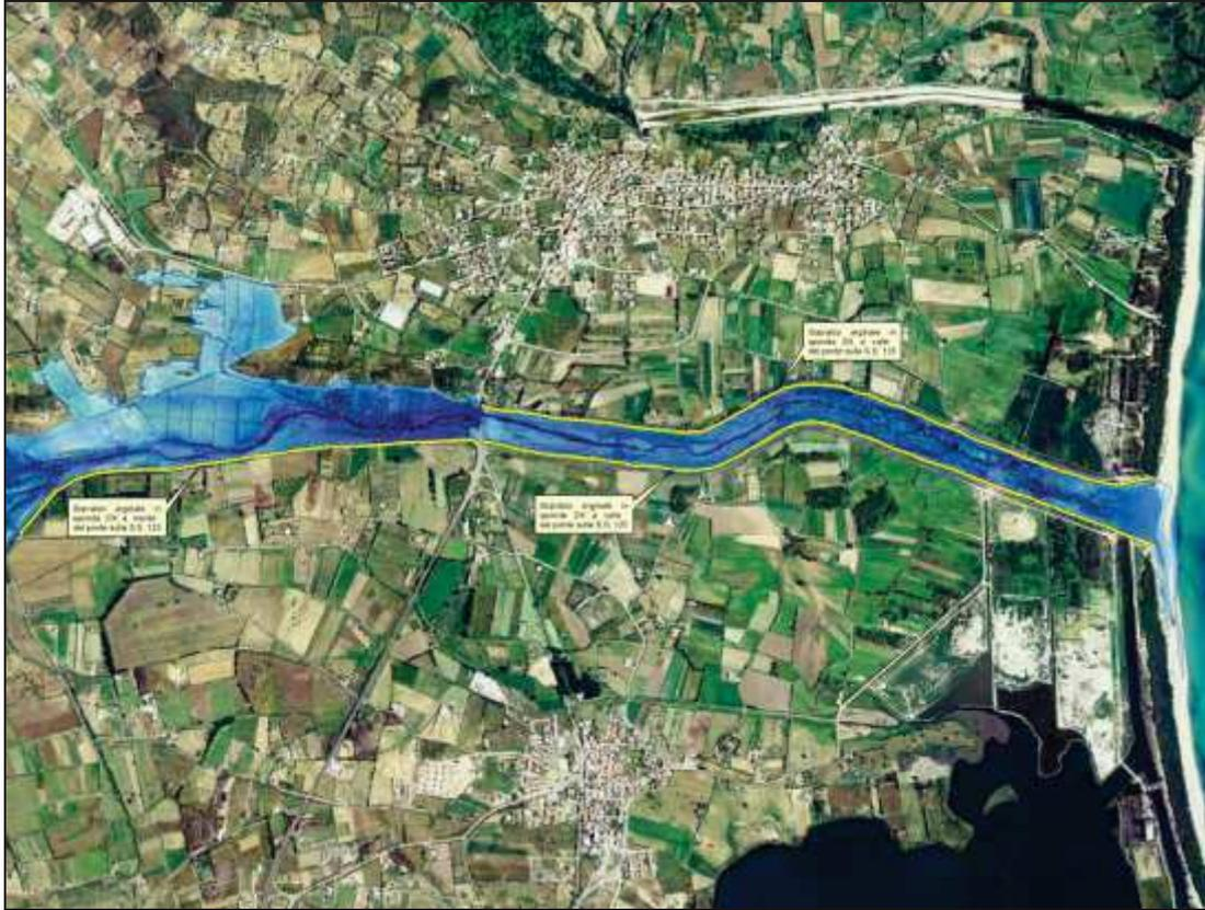
Figura 6.10 – Adeguamento in quota degli argini in sponda destra e sinistra a valle della SS 125 L = 2400 m .
