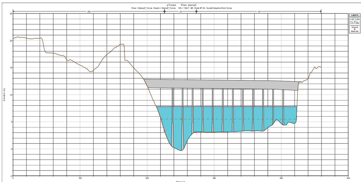
Figura 1.12 – Sezione bagnata in corrispondenza del ponte sulla SP 34
