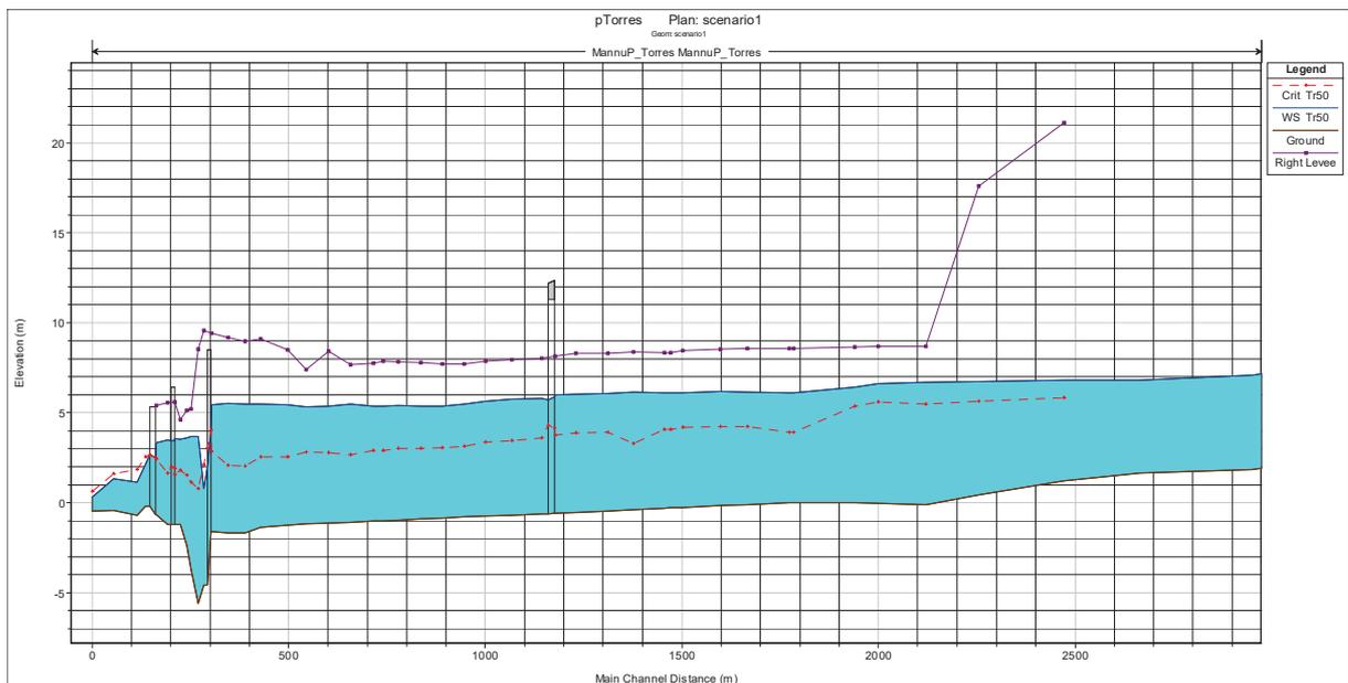
**Figura 2.2 - Profilo di corrente portata cinquantenaria PSFF in corrispondenza delle opere
