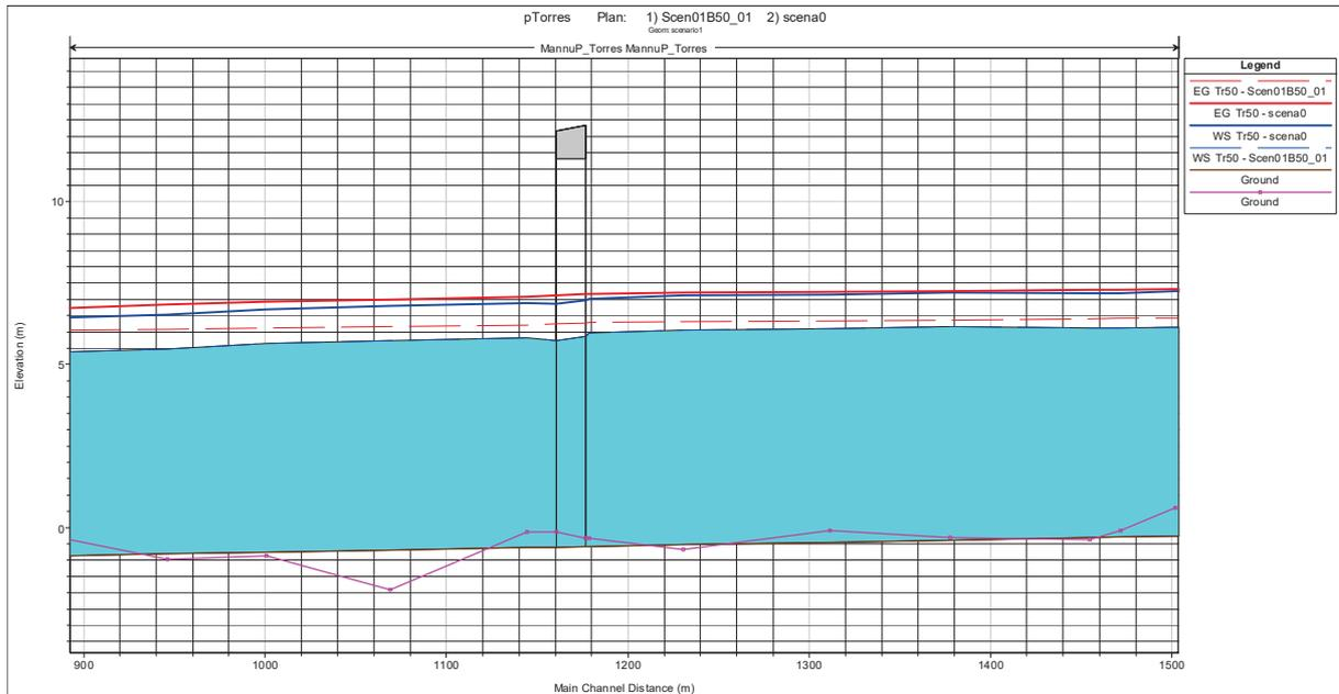
**Figura 2.5 - Comparazione tra i livelli idrici relativi alla piena cinquantenaria calcolati in corrispondenza del Ponte sulla SP34 nella situazione attuale (linea continua) e in quella di progetto scenario 1 (linea tratteggiata).**
