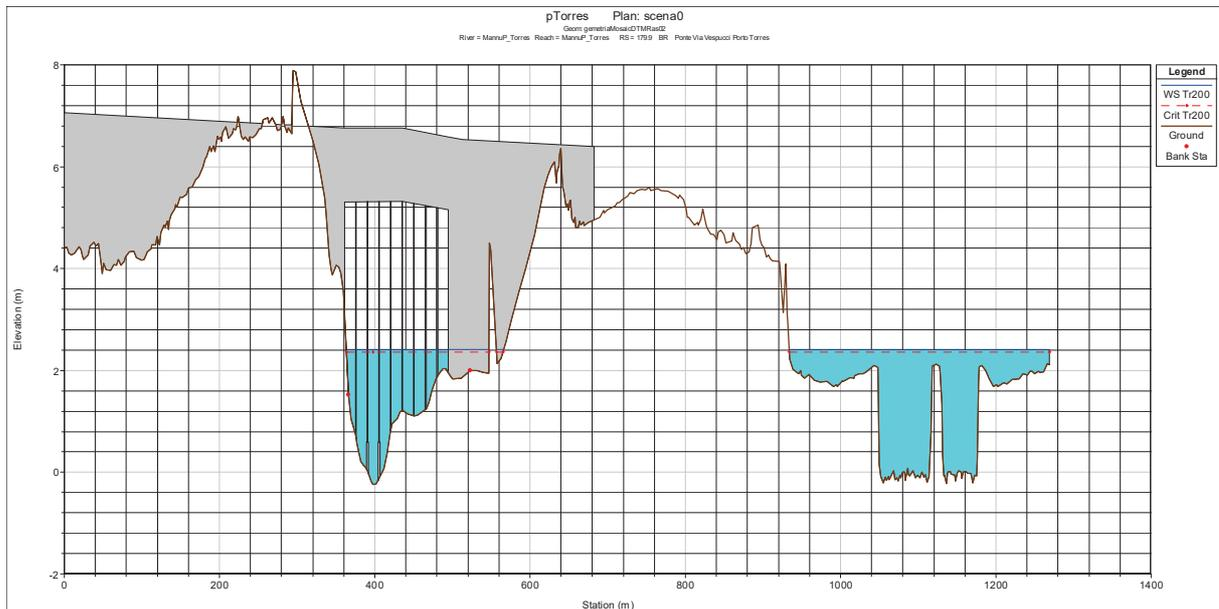
Figura 1.17 – Sezione bagnata in corrispondenza del ponte Vespucci
