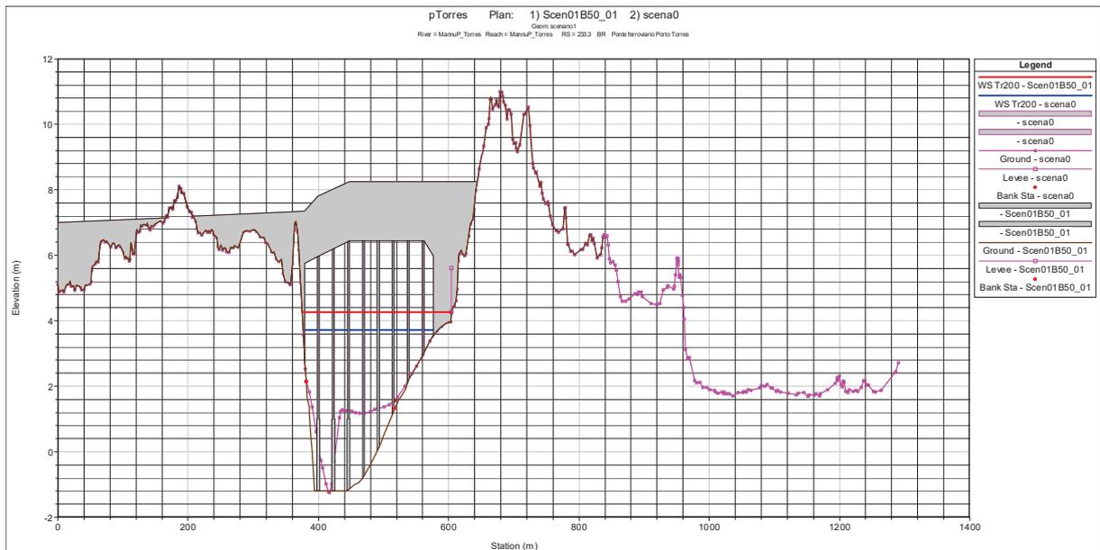
Figura 2.8 - Comparazione tra i livelli idrici relativi alla piena bicentenaria calcolati in corrispondenza del ponte ferroviario nella situazione attuale (in blu) e in quella di progetto scenario 1 (in rosso).
