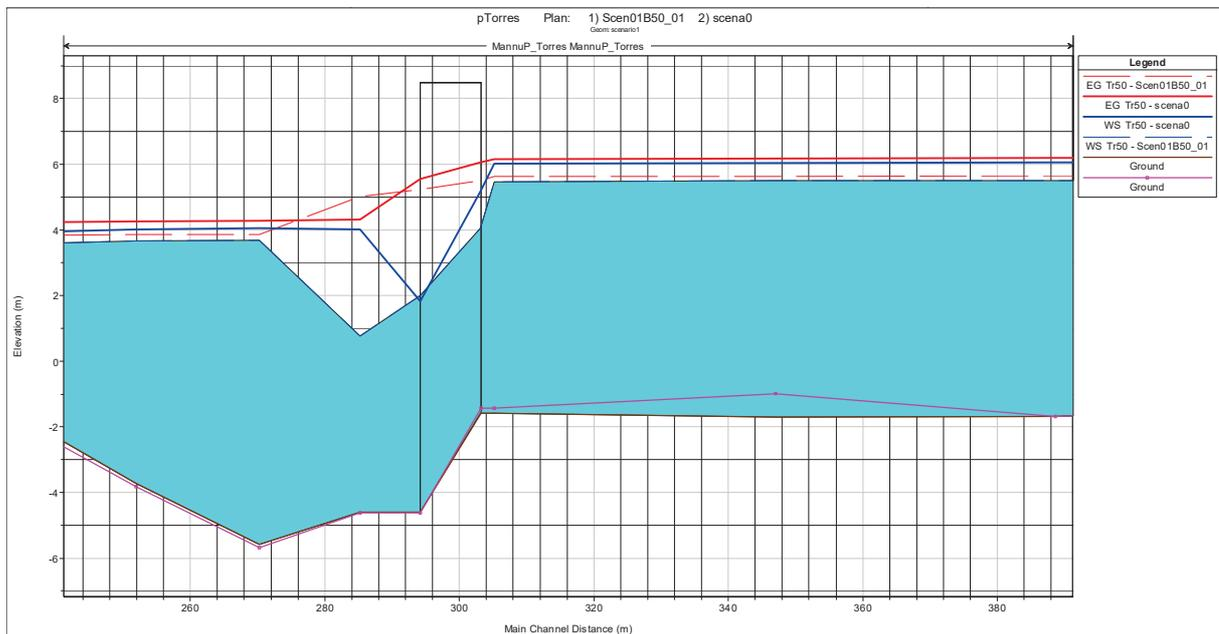
Figura 2.7 - Comparazione tra i livelli idrici relativi alla piena cinquantenaria calcolati in corrispondenza del Ponte sulla romano nella situazione attuale (linea continua) e in quella di progetto scenario 1 (linea tratteggiata).
