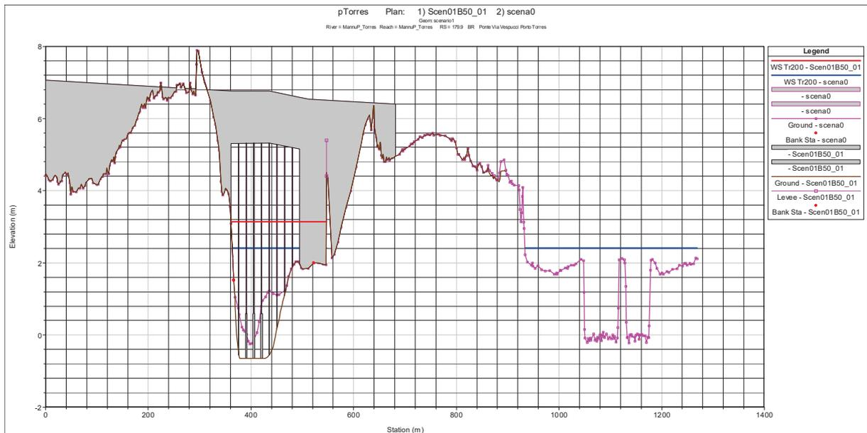
Figura 2.10 - Comparazione tra i livelli idrici relativi alla piena bicentenaria calcolati in corrispondenza del ponte Vespucci nella situazione attuale (in blu) e in quella di progetto scenario 1 (in rosso).
