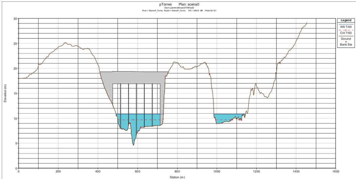
Figura 1.11 – Sezione bagnata in corrispondenza del ponte sulla SS 131
