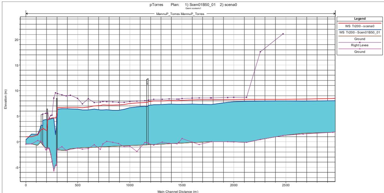
Figura 2.3 - Comparazione tra i livelli idrici relativi alle portate del PSFF (in rosso la condizione ex-Ante).
