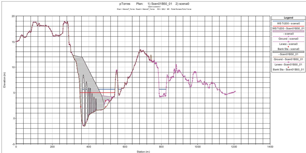
Figura 2.6 - Comparazione tra i livelli idrici relativi alla piena bicentenaria calcolati in corrispondenza del Ponte Romano nella situazione attuale (in blu) e in quella di progetto scenario 1 (in rosso).
