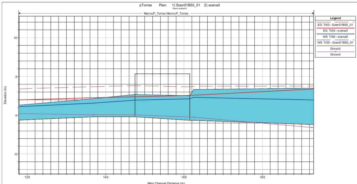
Figura 2.11 - Comparazione tra i livelli idrici relativi alla piena cinquantenaria calcolati in corrispondenza del ferroviario nella situazione attuale (linea continua) e in quella di progetto scenario 1 (linea tratteggiata).
