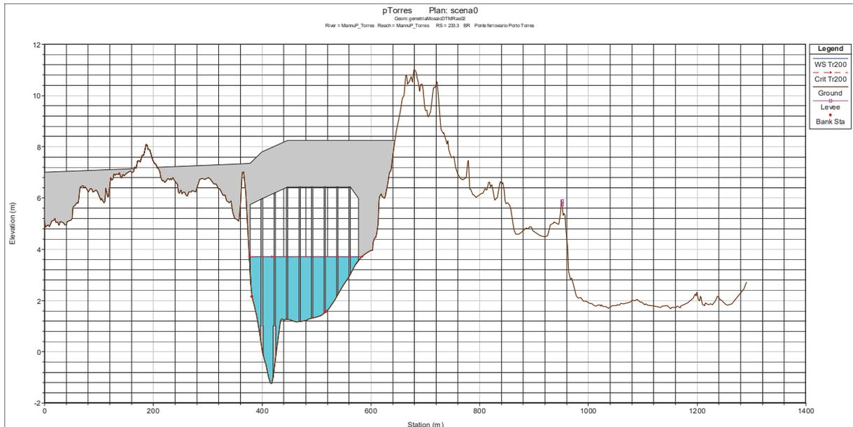
Figura 1.16 – Sezione bagnata in corrispondenza del ponte ferroviario
