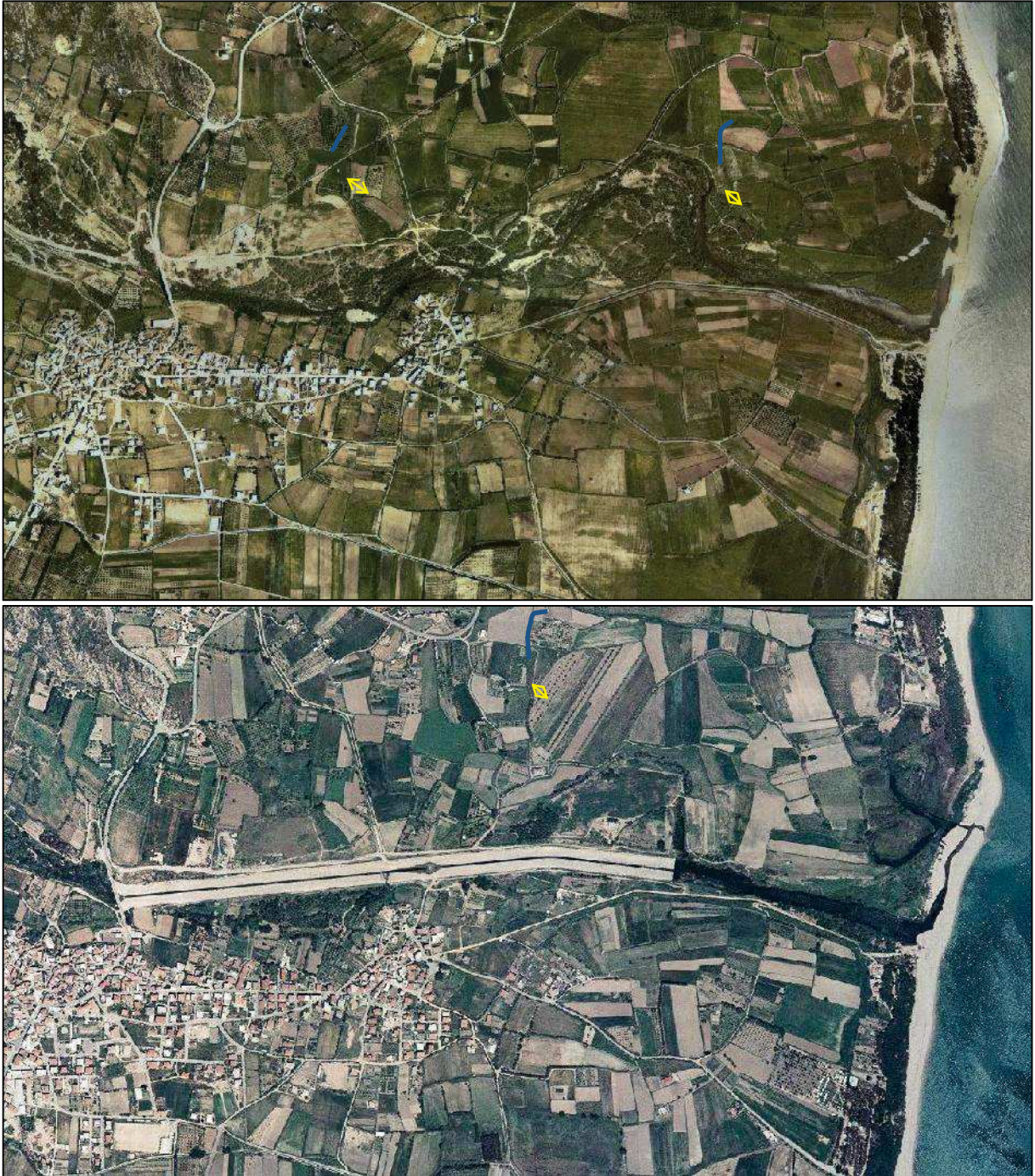
Figura 1.8 - Ortofoto anni 1977, 2000: in evidenza la profonda modifica apportata dall'opera: un evento di piena intenso potrebbe modificare la situazione attuale con la riattivazione del paleo alveo.
