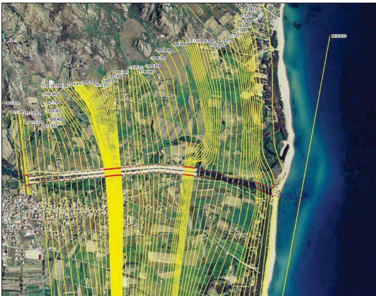
Figura 1.1 – Planimetria schematica del modello idraulico del Pramaera allo stato attuale a valle della SS 125
