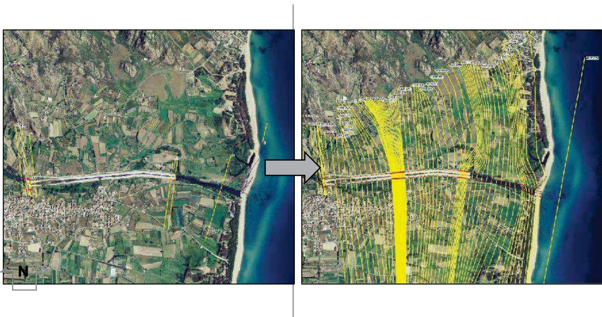
Figura 4.1 – Sezioni trasversali utilizzate nel modello idraulico del fiume Pramaera a valle della SS 125: a sinistra il modello del PSFF a destra il nuovo modello
