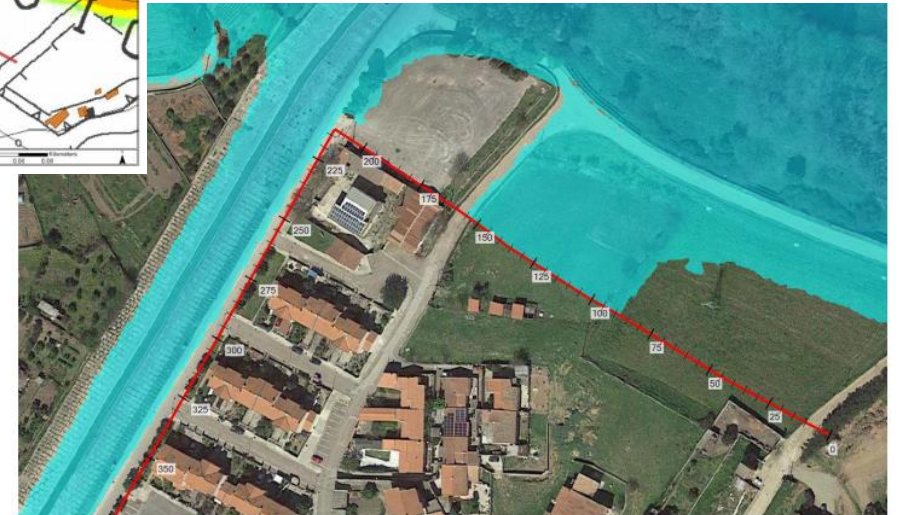
Nuova arginatura a protezione del centro abitato
