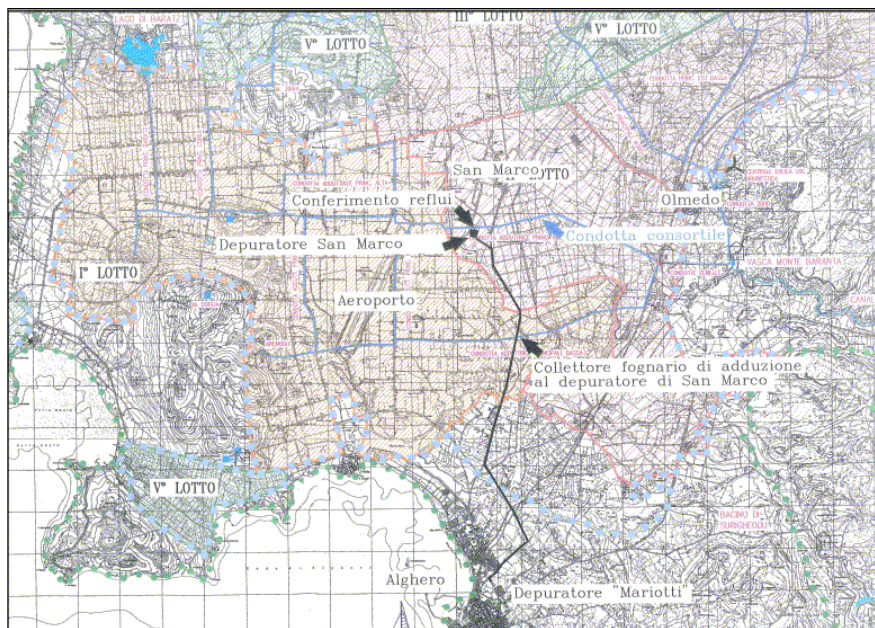
Figura 13) Planimetria della condotta di rilancio verso il nuovo depuratore San Marco
