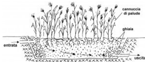
Figura 21) Sistema di fitodepurazione a flusso orizzontale
