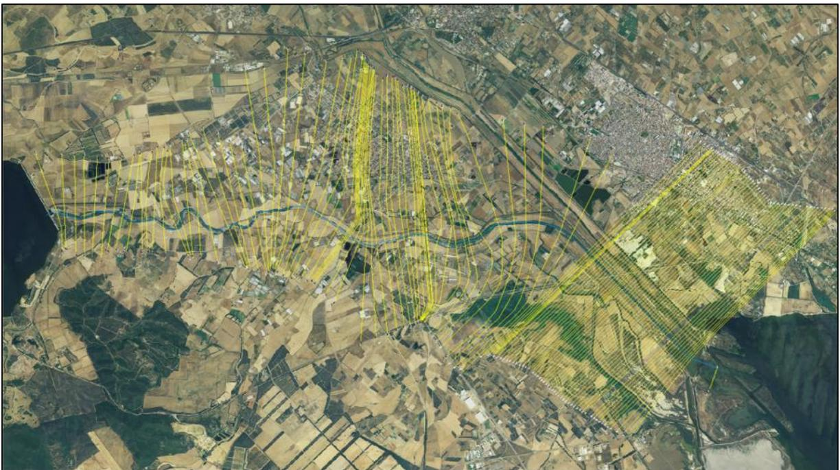
Figura 1.10 – Sezioni del modello idraulico del Riu Cixerri aggiornato - stato attuale
