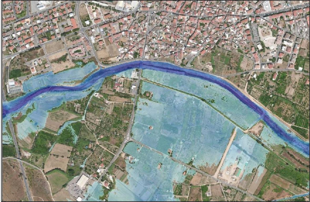
**Figura 1.30 – Aree e battenti idrici ottenuti per T50 nel centro abitato con modellazione aggiornata**
