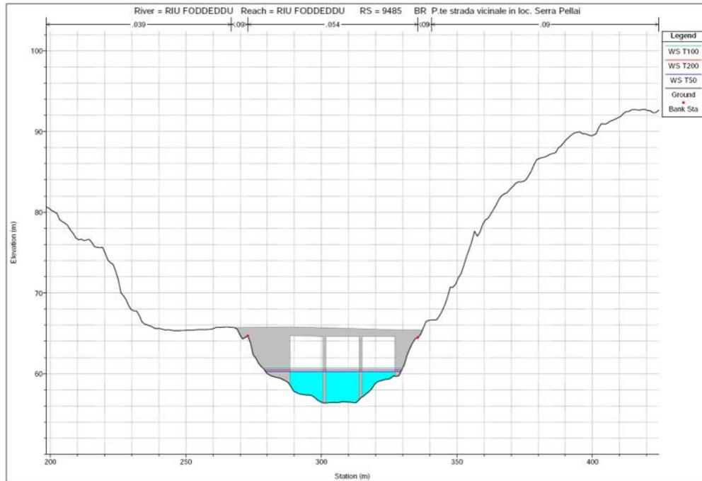
Figura 1.42 – Ponte strada vicinale in loc. Serra Pellai sufficiente per tutti i tempi di ritorno considerati
