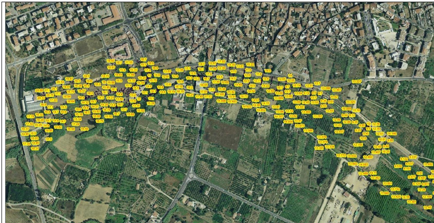
Figura 1.1 – Rilievo topografico dell'alveo con GPS eseguito nel 2013
