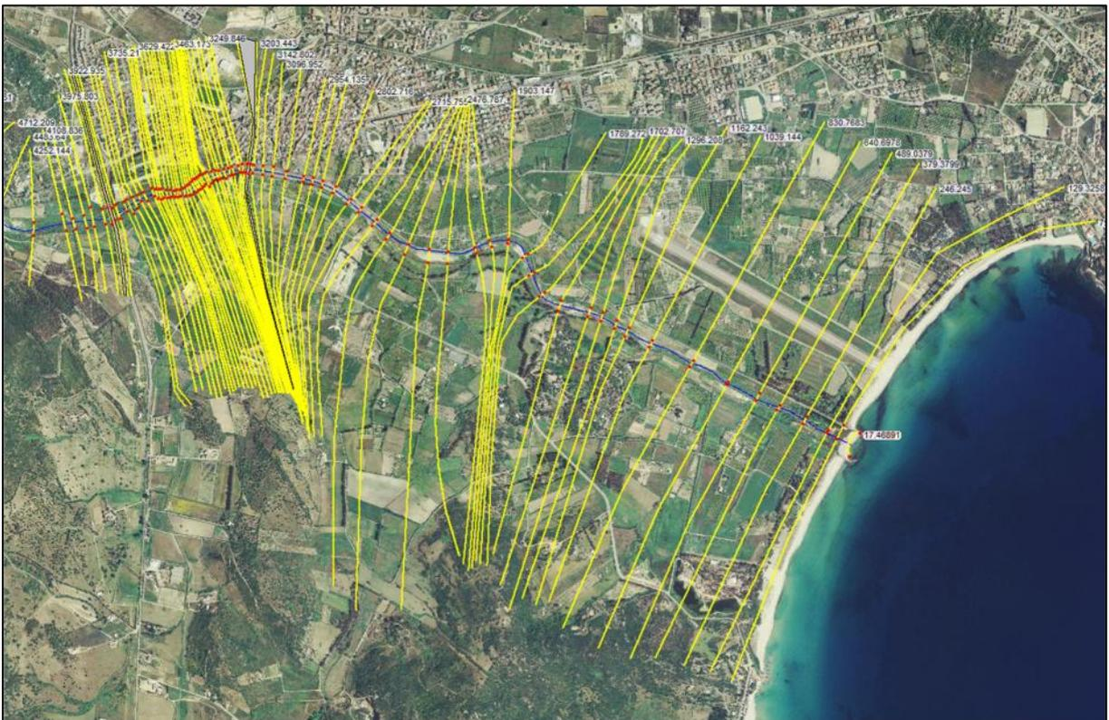
Figura 1.10 – Sezioni del modello idraulico aggiornato a valle della SS 125
