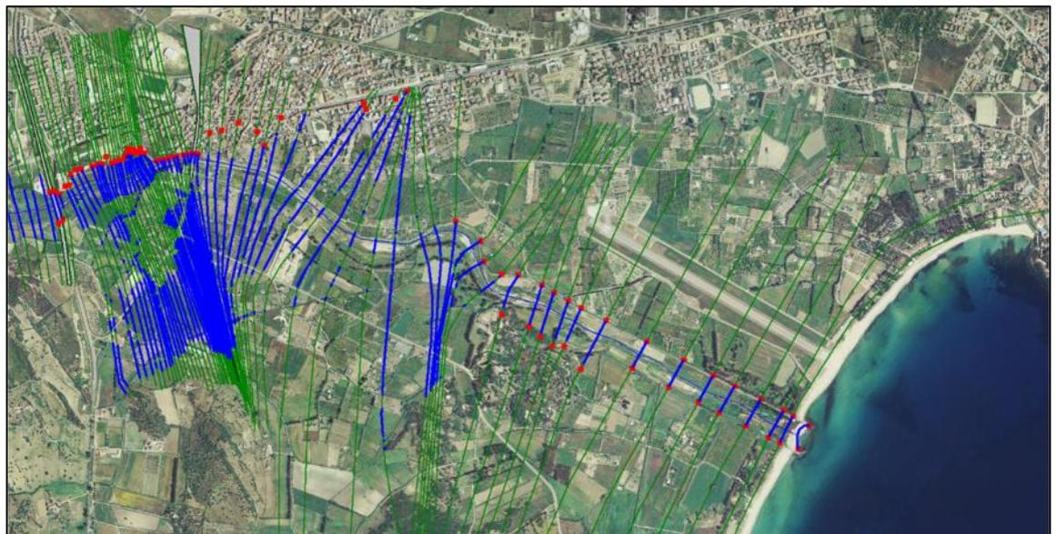
Figura 1.15 – Schema adottato per la simulazione dello scenario 0 per T100: in rosso la posizione dei levee
