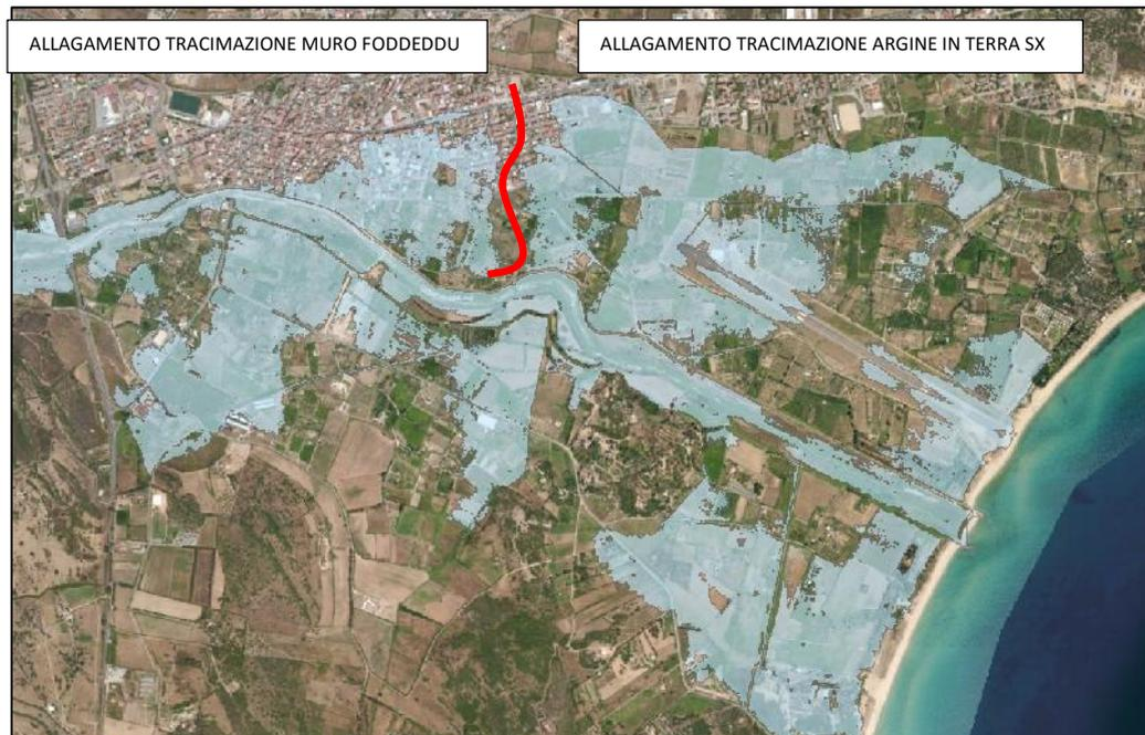
Figura 1.14 – Aree di allagamento per T100 con modellazione intermedia ad argini completamente tracimabili
