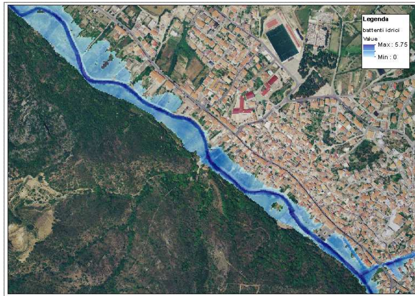
Figura 1.17 - Aree allagate nel tratto compreso tra la confluenza con il Rio Bau Porcos e la fine dell'abitato (Tr=50 anni)
