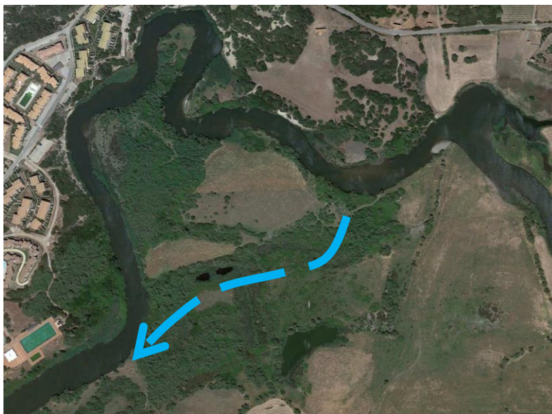
Figura 7.16 - Tratto fluviale in corrispondenza delle anse con l'erosione della duna costiera in prossimità degli edifici di un insediamento. La freccia indica un braccio fluviale che attualmente si riattiva solo in occasione delle piene provenienti in buona parte dai rilasci dagli sbarramenti a monte
