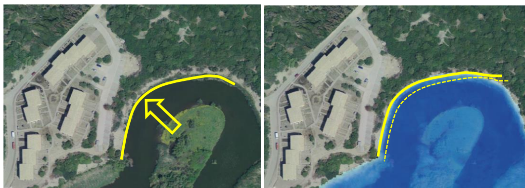
Figura 7.10 – Azioni erosive in atto lungo la sponda esterna del meandro all'inizio del tratto focivo.
