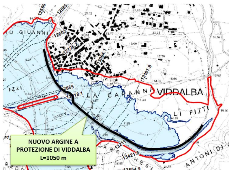
Figura 7.4 – Planimetria di allagamento corrispondente alla piena bicentenaria e intervento di arginatura a protezione di Viddalba (il tratto rosso indica l'esondazione come da PSFF)
